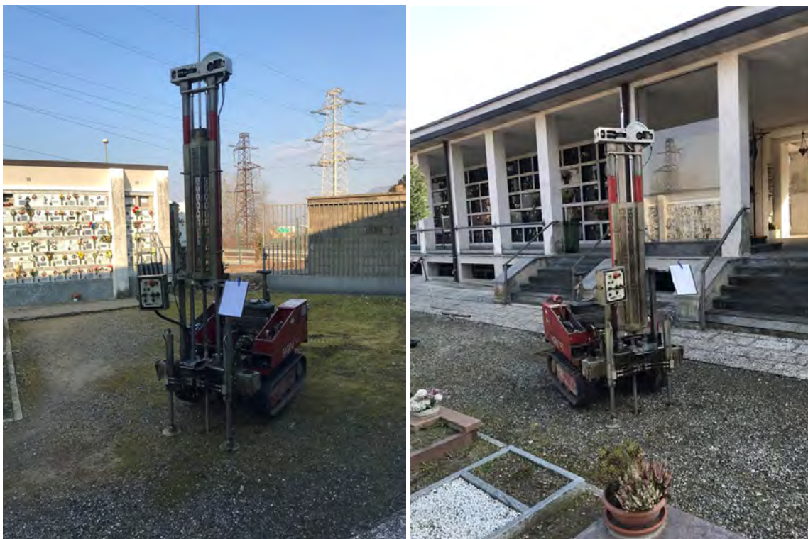
Esecuzione delle prove penetrometriche.
